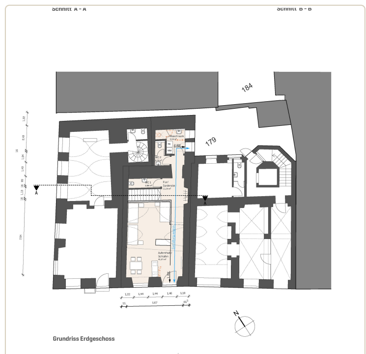
Grundriss Erdgeschoss – Einheit farblich hervorgehoben (Auszug Bauvorlage)
